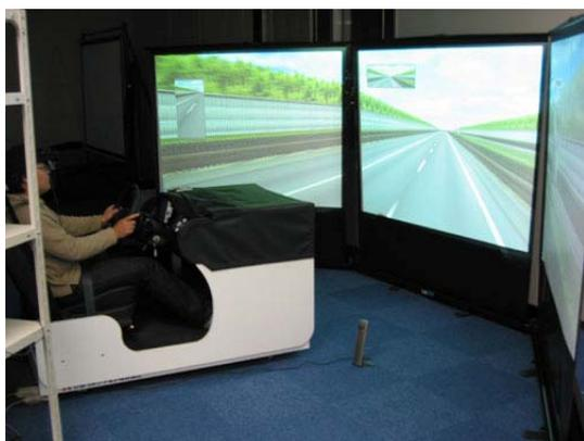
図1 定置型ドライビングシミュレータ
