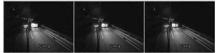
Fig. 10 検出結果：後続車両が遠い場合。 (左:全探索、中:間隔=1、右:間隔=5)
