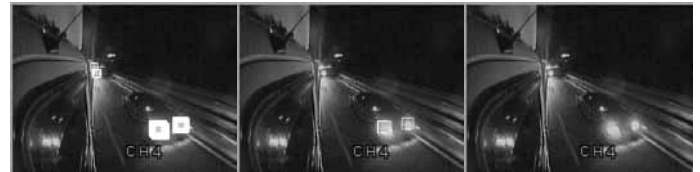
Fig. 11 検出結果：後続車両が近い場合。 (左:全探索、中:間隔=1、右:間隔=5)
