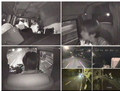
図2. 運転画像記録システムによる記録画像例 (左上から，運転員俯瞰画像，運転員近影，運転員後頭部画像，長距離運転行動データ計測装置による記録画像)
