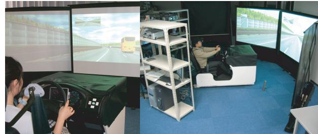
図1.1 ドライビングシミュレータ
