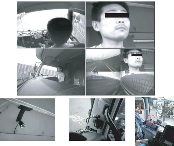
図3.3 運転画像記録システムにより得られた画像と設置したカメラ（後方、側方、正面からの3画像を記録します。）
