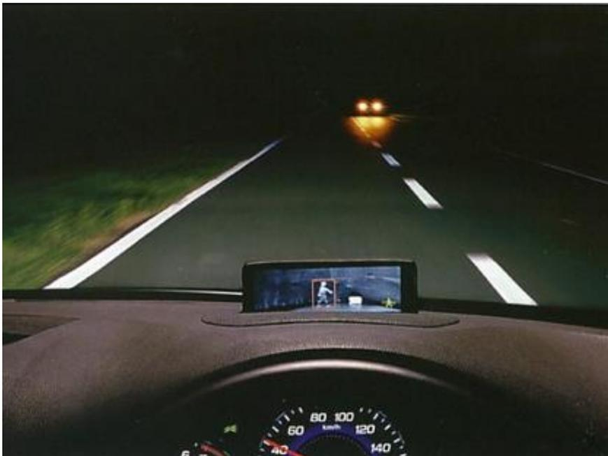
車載の暗視カメラで捕らえた前方映像を解析し、その中に歩行者が映っていることを検知したとき、歩行者に枠をつけてディスプレイに表示（注意喚起）
