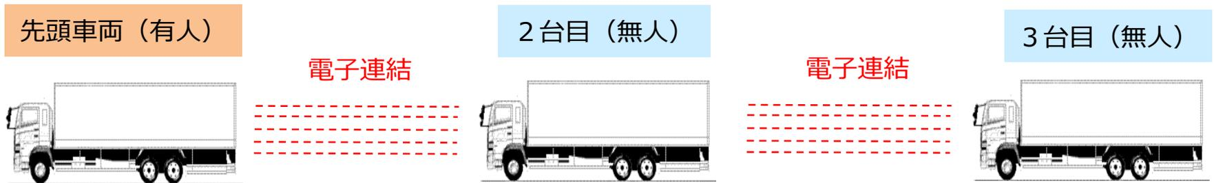
最高速度は 80 km/h。被牽引車は 2 台まで。車間は 10m。隊列の全長は最長で 56m。
